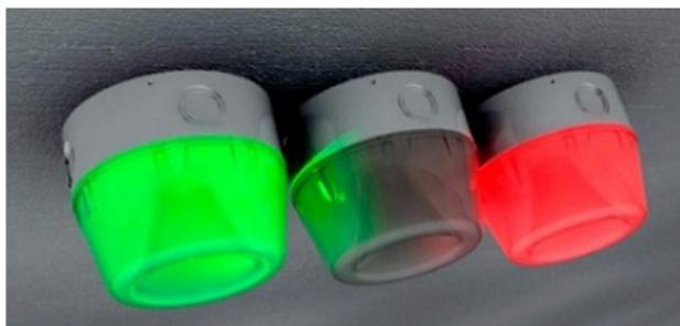
Рис.8 Общий вид детекторов присутствия автомобиля (ДПА).
