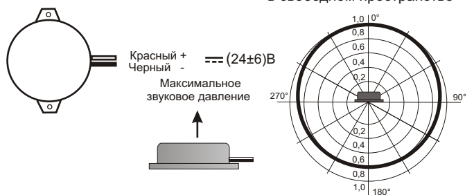
Рис.2 Схема подключения и диаграмма направленности оповещателя ПКИ-МШ (Шмель-24V).
