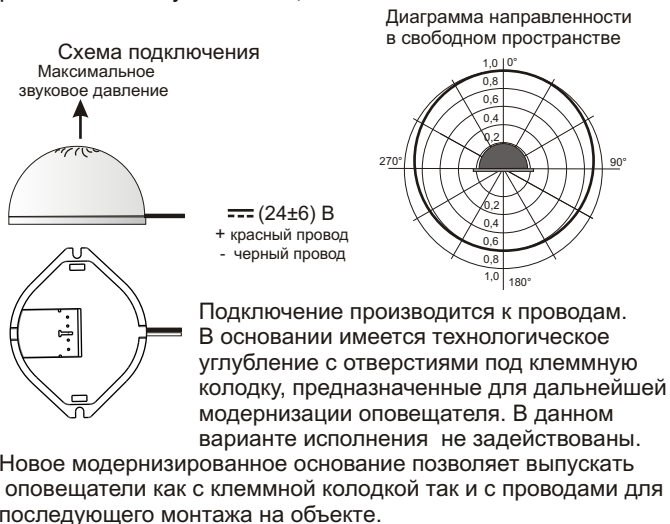
Рис.2 Схема подключения и диаграмма направленности оповещателя.
