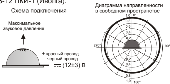
Рис.2 Схема подключения и диаграмма направленности оповещателя ОПЗ-12 ПКИ-1 (Иволга).
